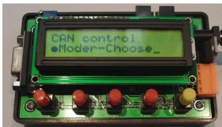
该分析仪不需要上位机就能实现开发、测试、维护、管理CAN-bus 网络，功能通用而且非常强大。能够处理11 位标志符模式（CAN2.0A 协议）和29 位标识符模式（CAN2.0B 协议）的CAN 报文。客户可以根据自己的要求，只需通过按键对界面的操作即可改变设定。包括更改ID号、工作模式、波特率、数据帧格式、数据发送和接收、以及与RS232的相互转换功能等等。
