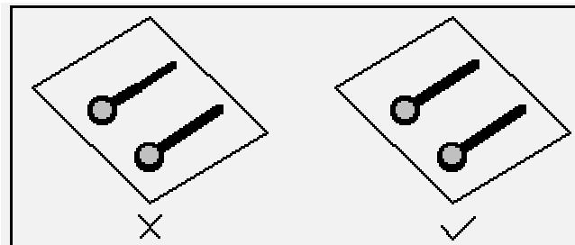
同一网络的布线宽度应保持一致，线宽的变化会造成线路特性阻抗的不均匀，当传输的速度较高时会产生反射，在设计中应该尽量避免这种情况。在某些条件下，如接插件引出线，BGA封装的引出线类似的结构时，可能无法避免线宽的变化，应该尽量减少中间不一致部分的有效长度。
