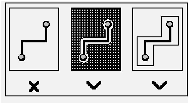
对应地线回路规则，实际上也是为了尽量减小信号的回路面积，多见于一些比较重要的信号，如时钟信号，同步信号；对一些特别重要，频率特别高的信号，应该考虑采用铜轴电缆屏蔽结构设计，即将所布的线上下左右用地线隔离，而且还要考虑好如何有效的让屏蔽地与实际地平面有效结合。
