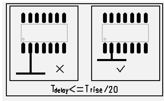
尽量控制分枝的长度，一般的要求是 $T_{delay} \leq T_{rise} / 20$ 。
