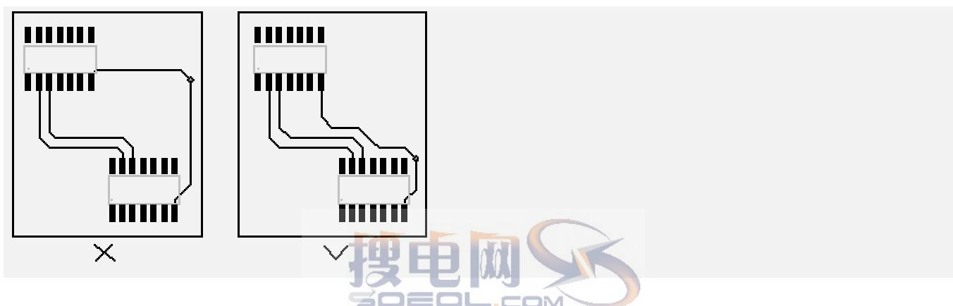
环路最小规则，即信号线与其回路构成的环面积要尽可能小，环面积越小，对外的辐射越少，接收外界的干扰也越小。针对这一规则，在地平面分割时，要考虑到地平面与重要信号走线的分布，防止由于地平面开槽等带来的问题；在双层板设计中，在为电源留下足够空间的情况下，应该将留下的部分用参考地填充，且增加一些必要的孔，将双面地信号有效连接起来，对一些关键信号尽量采用地线隔离，对一些频率较高的设计，需特别考虑其地平面信号回路问题，建议采用多层板为宜。
