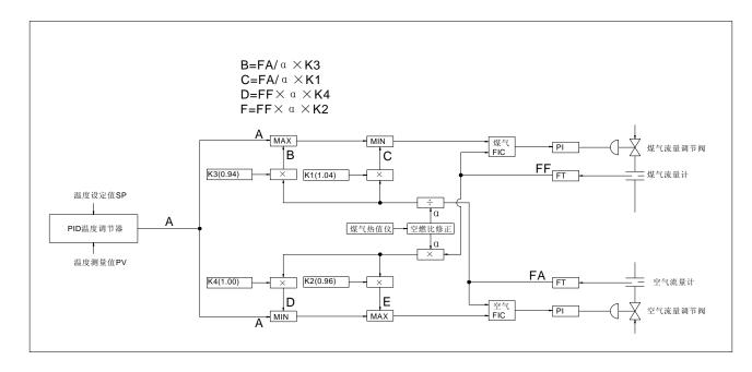
PID 温度调节器的温度设定值 SP 由计算机/HMI 人工手动设定;每个控制区的测温热电偶采集的温度信号为温度测量值 PV。PID 温度调节器的输出为 A
