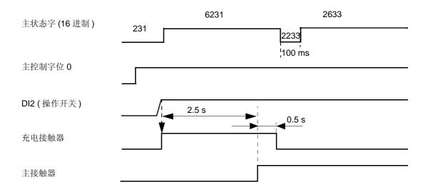
调制器是通过主控字 (MCW) 位 3 的高电平来启动,通过位 3 的低电平来停止。调制器仅在直流母排的充电完成之后,才能启动。
