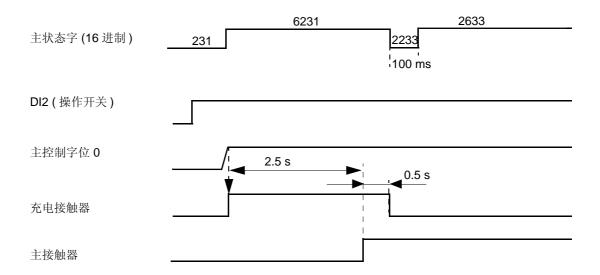
• 方式 2: 通过数字输入 DI2 的上升沿 (例如,柜门上的操作开关先调到位 START,接着调到位 1),同时主控制字 (MCW) 位 0 的高电平。
