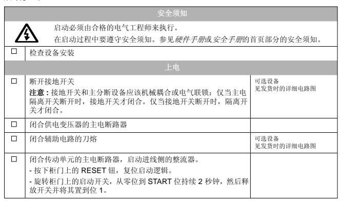
注意:在正常启动步骤或正常使用下,进线侧整流器参数不必设置!
