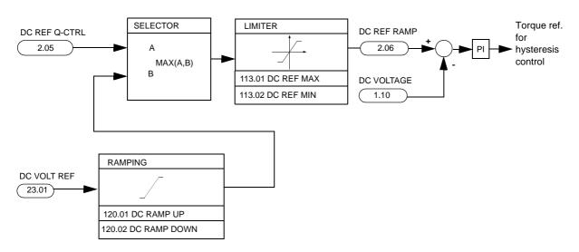
直流电压控制器确保直流母线电压在所有负载条件下为预设给定值。控制器的输入,例如,给定和实际测量值之间的误差值,是从直流电压测量值,积分值和限幅的直流给定值计算出来的。直流电压 PI 控制器的输出就是转矩的给定,用来实现转矩滞环控制。
