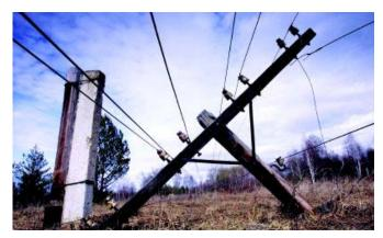
棒(经事后检查,拉棒地下部分严重锈蚀,西南侧拉棒在地下 1.03m 处、西北侧拉棒在地下 1.16m 处断开)突然断开,电杆向东面倾倒,陈某随杆落地(安全带、后备保护绳系在杆上),因受伤严重,抢救无效,于当日死亡。
