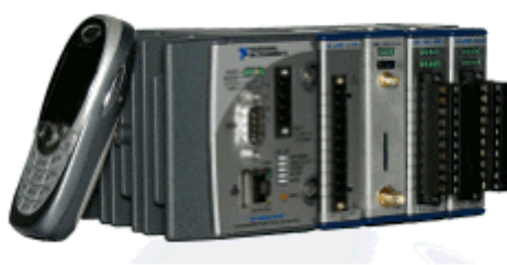
图 3. cRIO Gxxx 模块与 NI CompactRIO 系统(感谢 S. E. A 提供)
