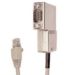
netLINK 一端为 D9 接口, 直接插到西门子 PLC 的 MPI 或者 PROFIBUS 口上, 不需要外接电源; 另一端为 RJ45 接口, 直接连接到 PC 机或者交换机, 可以实现单个控制系统上位监控, 也可以实现多个控制系统联网。
