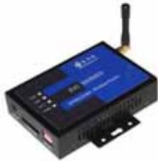
GPRS/CDMA 无线路由器能使您的局域网共享 GPRS/CDMA 无线连接。具有地址转换(NAT)以及其它的网络服务功能。把 GPRS/CDMA 无线路由器连接到以太网上, 适用于地理位置分散, 建设周期短, 数据中小流量, 组网复杂, 需要支持应用层协议的远程数据传输。GPRS 理论带宽可达 171.2Kbit/s, 实际应用带宽大约为 40~100Kbit/s; CDMA 1X 理论带宽可达 300Kb/s, 目前的实际应用带宽大约在 100Kb/s 左右(双向对称传输)。
