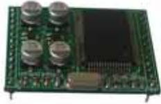
串口 PPP 拨号模块有嵌入式(CD10E)和外置式(CD10)两种。CD10E 内嵌于 GPRS/CDMA/PSTN Modem 数传终端中，CD10 可以用 RS232 串口与 GPRS/CDMA/PSTN Modem 外接，它们在功能上相同。串口 PPP 拨号模块配合 GPRS/CDMA/PSTN Modem 等模块工作，它的主要任务是控制这些模块拨号上网，同时它提供串口透明传输用户数据。它内置 PPP，TCP/IP 协议栈。对于通信设备制造商而言，研发网络技术需要花费大量的人力，物力和财力。使用串口 PPP 拨号模块，可以立即实现 GPRS/CDMA/PSTN 数传。
