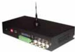
GPRS/CDMA 无线网络视频服务器是利用现有的 GPRS/CDMA 网络传输视频信号，实现无线的、移动的视频监控。可用于车载视频监控、野外视频监控等。它由音视频编码器、GPRS/CDMA 模块、天线接口、音视频接口、RS422/RS485 串行接口、RS232 串行接口等构成。可配合计算机中心控制软件实现大系统组网方案，提供开放的 SDK，供用户或第三方厂商开发和构建新的应用方式。支持多路并传。根据 GPRS/CDMA 模块的个数，可以分为多款产品。
