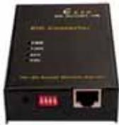
UPS SNMP 适配器用于连接具有串口接口的 UPS 电源设备到以太网网络。使得 UPS 电源设备具备 SNMP 网管功能。UPS 电源设备作为 SNMP 网管的代理端 (agent)。
