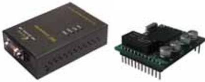
串口设备联网服务器包括外置式和嵌入式两种，外置式是一个可以让工业用的 RS232/485/422 串口设备立即具备联网能力的设备联网服务器。它是连结工业用串口设备及以太网络的最佳通信解决方案。嵌入式是一块可以让设备制造商整合到产品内部的板卡。支持 TTL 和 232 接口，10M 以太网接口。
