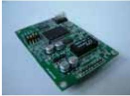
以太 PPP 拨号模块有嵌入式(ED10E)和外置式(ED10)两种，ED10E 内嵌于 GPRS/CDMA/PSTN Modem 网络终端中，ED10 可以用 RS232 串口与 GPRS/CDMA/PSTN Modem 外接，它们在功能上相同。以太 PPP 拨号模块配合 GPRS/CDMA/PSTN Modem 等模块工作，它的主要任务是控制这些模块拨号上网，同时它提供以太网接口透明传输网络 IP 数据。它内置 PPP，TCP/IP 协议栈。对于通信设备制造商而言，研发网络技术需要花费大量的人力，物力和财力。使用以太 PPP 拨号模块，可以立即实现 GPRS/CDMA/PSTN 网关和路由器。
