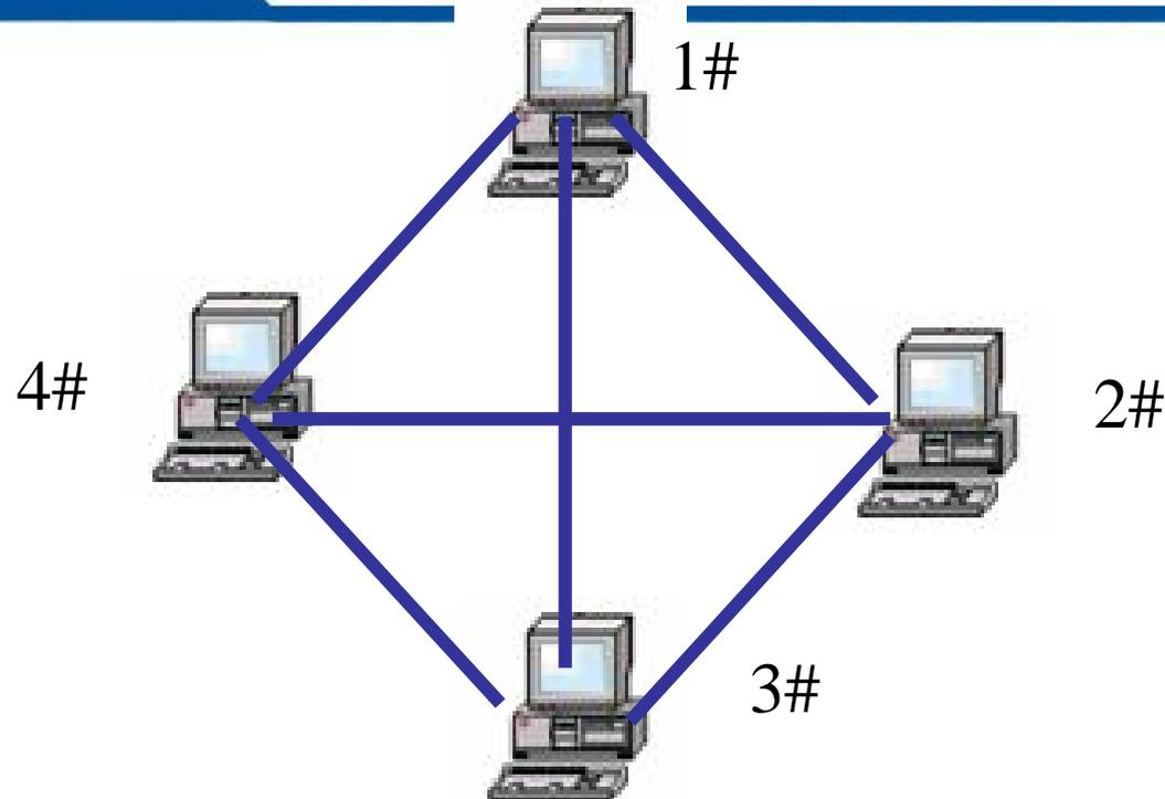
Ø 将设备直接两两相连
