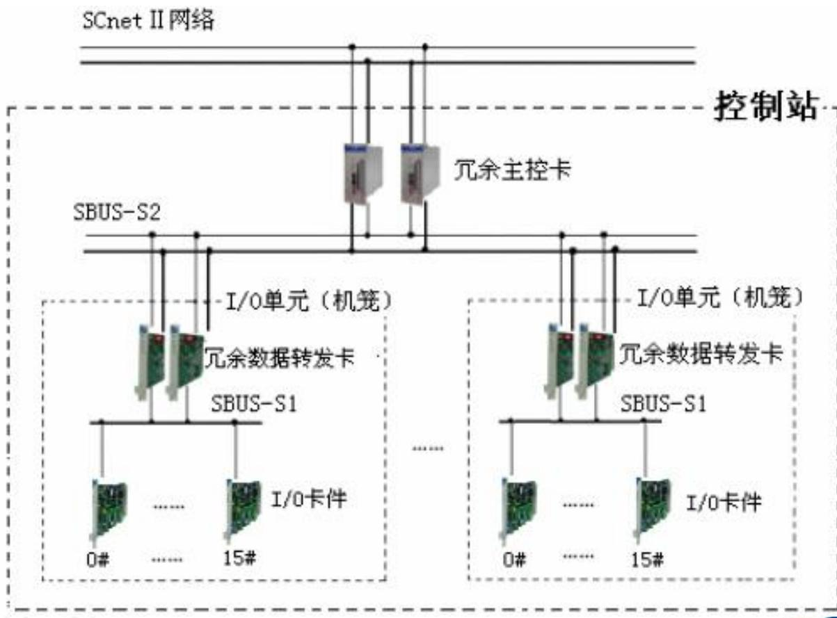
Ø SBUS-S2总线基于10M/100M冗余工业以太网构建，是系统的现场总线，物理上位于控制站所管辖的I/O机笼之间，连接了主控制卡和数据转发卡，用于主控制卡与数据转发卡间的信息交换。
