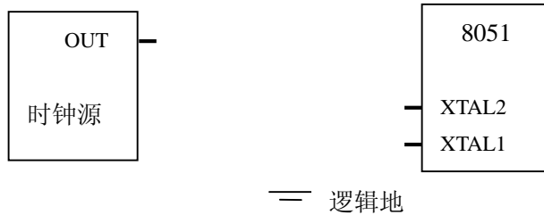
图 1-3 8051 外部时钟接入示意图
