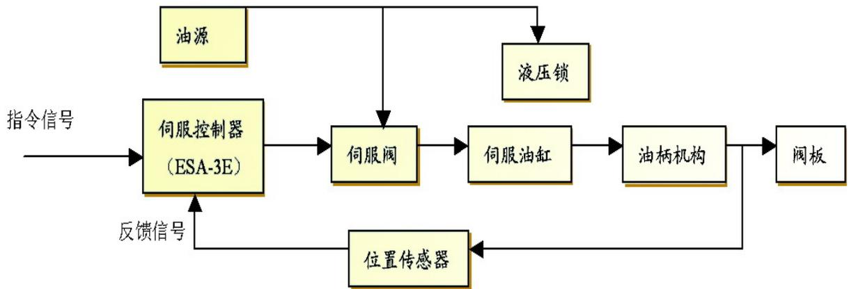
图 1 电液伺服控制系统原理框图
