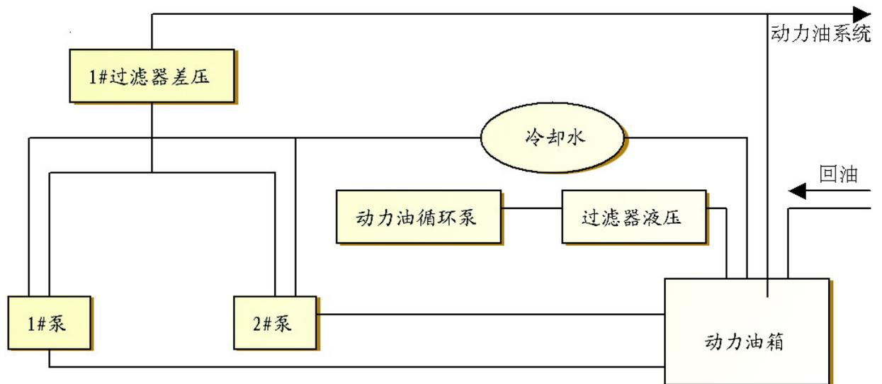
图 2 动力油系统控制框图
