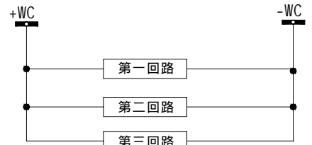
图6-8 回路短路的检查示意图
