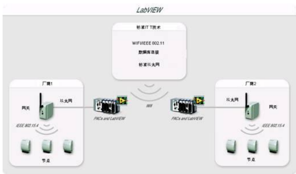
图 1：混和测量系统利用开放式软件平台，将基于不同通信总线或是厂商的测量产品整合在一起。
