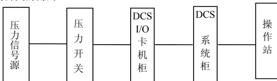
压力高报（低报）时，以缓慢的速度调整压力信号源，压力增至（减至）报警设定点时，观察操作站 CRT 显示，压力开关接点的动作情况，再缓慢减小（增加）压力，检查压力开关的复位和回差。
