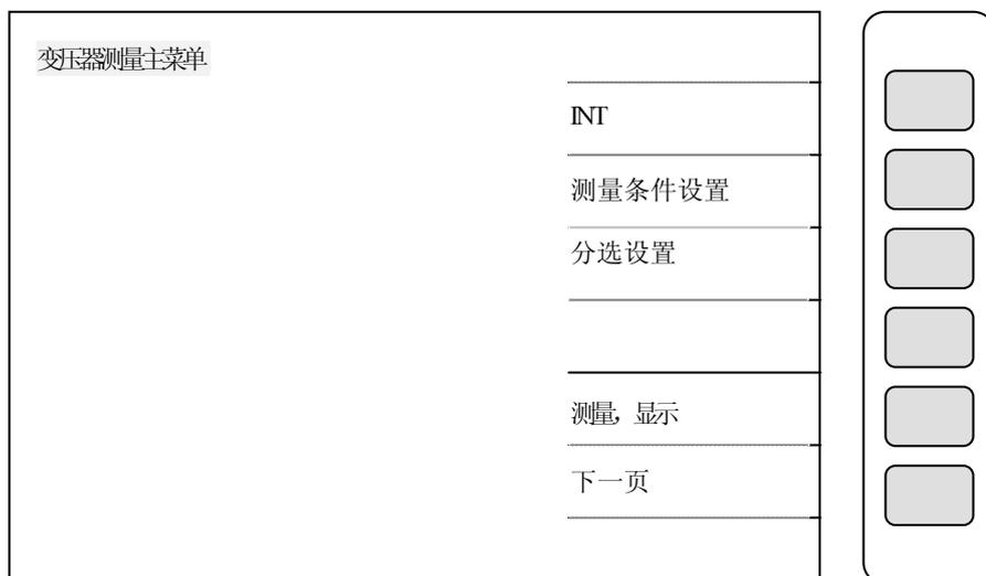
2. 当进入此画面后，请按下[测量条件设置 (test condition) ]键进入测试条件设定画面，设定各项参数如下图：
