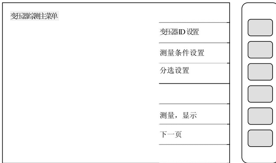
2. 请按上图按键[变压器 id 设置(transformer id)], 进入变压器扫描测试功能 ID 设定画面, 则显示器画面出现如下图:
