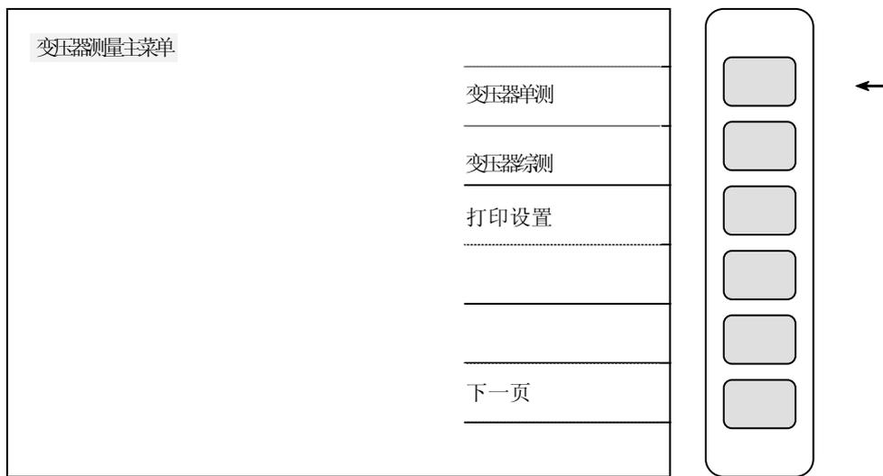
请按上图箭头所指之按键[transformer]，进入变压器单机测试功能设定画面，则显示器画面出现如下图：
