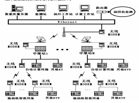
中心控制室为上级站。上级站完成所有中继站、远程终端设备的登记,计量站所辖油、水井终端和自动计量的参数设置,现场各类测控信息的采集管理、储存、分析、诊断,可实时控制和监测底层各远程终端。
