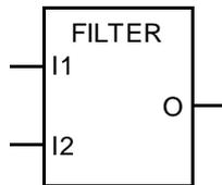
**运算** 输出等于输入端 I1 的过滤值。输入端 I2 为过滤时间。
