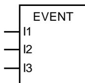
**运算** 输入端 I1 触发事件。输入端 I2 选择参数索引值，从该参数中读取事件信息（字符串）。输入端 I3 选择事件类型（警告或故障）。
