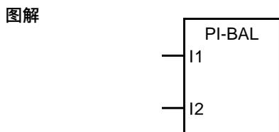
**运算** 该块首先初始化 PI 功能块。当输入端 I1 的值为真时，该块将 I2 的值写入 PI 块的输出端。当输入端 I1 的值为假时，该块断开与 PI 功能块的连接，使其继续进行正常的输出操作。
