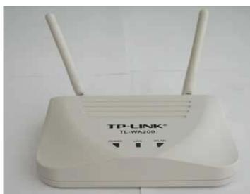
TL-WA200 基于 802.11b 标准, 可以最高提供 11Mbps 的传输速率, 有效传输距离在室内为 120 米, 室外为 350 米。提供 256bit 的 WEP 加密, 数据传输的安全性较高。它还提供了作为无线 AP, 提供无线网卡的接入;
