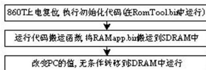
图3 从Flash到SDRAM搬运代码的过程
